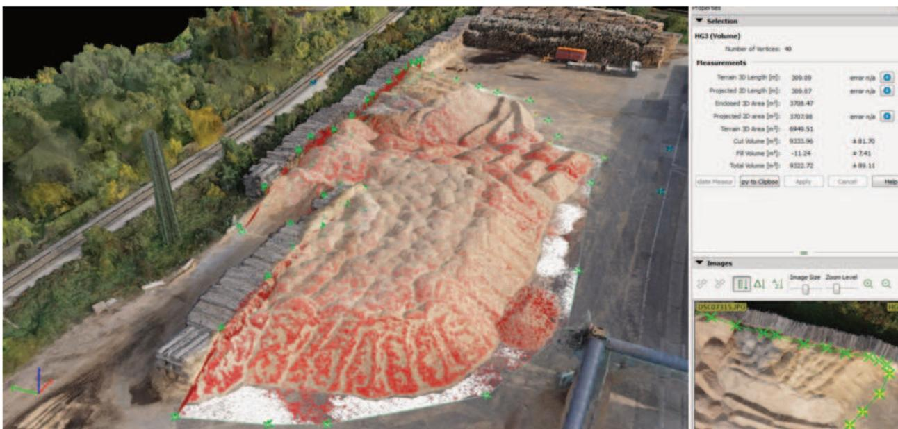
Fig. 4: 3D-Punktwolke zur Kubaturberechnung einer Hackgutschüttung (Volumen 9300 m³)
