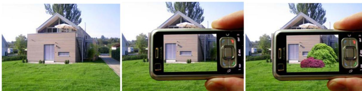
Abbildung 1: Prinzipskizze zur Funktionsweise eines Planungs- und Beratungssystems (vereinfachte Darstellung): v.l.n.r. Der Anwender plant auf einer Grünfläche Gehölze zu pflanzen (1); über die Kamera eines mobilen Endgeräts wird das Live-Video aufgenommen, mittels GPS und weiterer präzisen AR-Tracking-/Registrierungsverfahren werden Position und Ausrichtung der Kamera ermittelt (2), der Anwender wählt Pflanzenarten aus, Billboards/3D-Modelle der gewählten Pflanzenarten/-sorten werden maßstabsgerecht in das Videobild projiziert (3). Der Anwender hat nun die Möglichkeit, die Pflanzenauswahl aus visuell-ästhetischer Sicht zu beurteilen.
